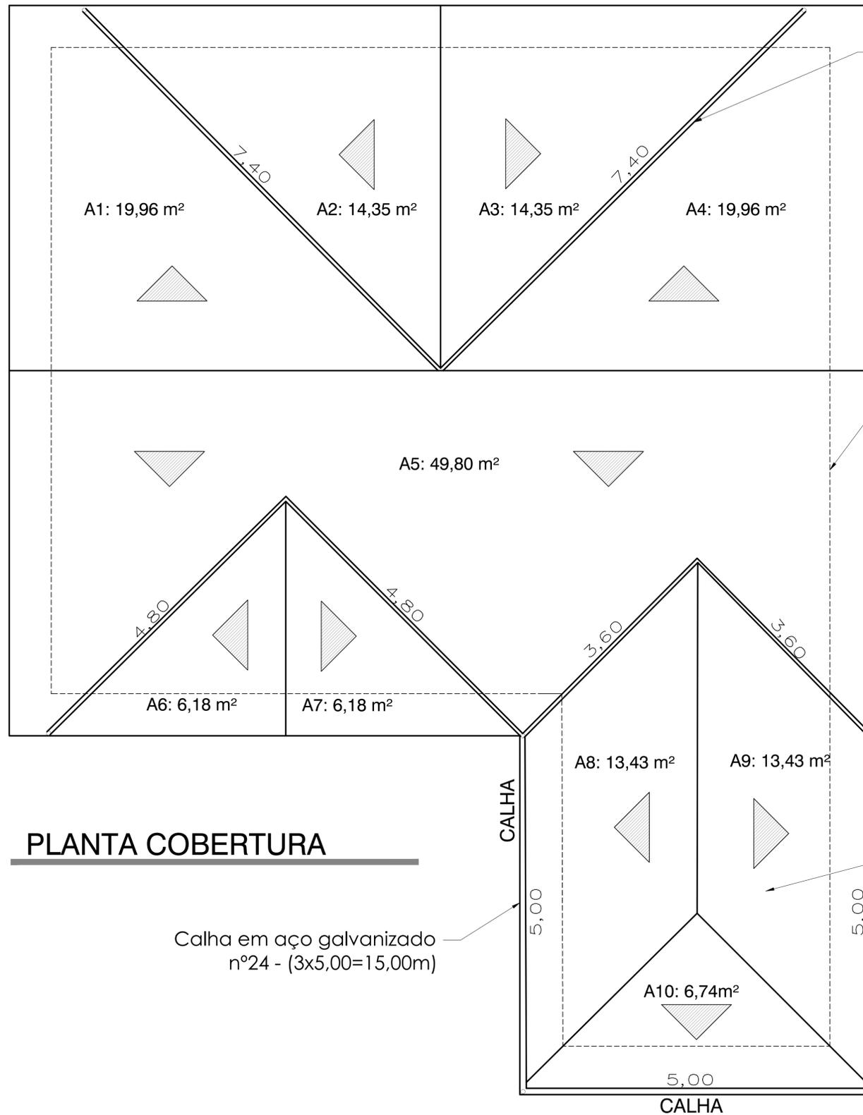
Calha p/água furtada em chapa de aço galvanizada 31,60m.
